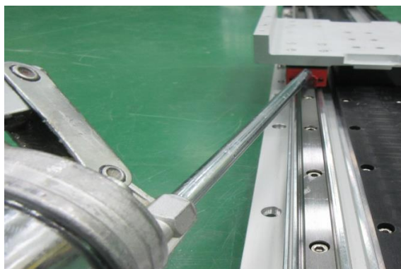
Rys. 7.7: SSA 13, 18, 20 Zestaw konserwacyjny smar
